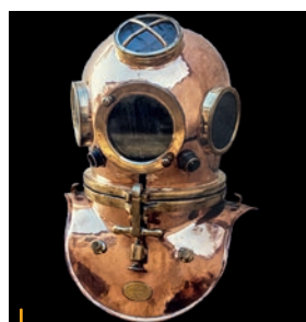
Le casque Charles Petit modifié en Boutan choisi pour sa rapidité de manipulation car les essais de l'appareil demandant de nombreux réglages avec à chaque fois plusieurs immersions et sorties d'eau. (Photo J. Abdoun).
