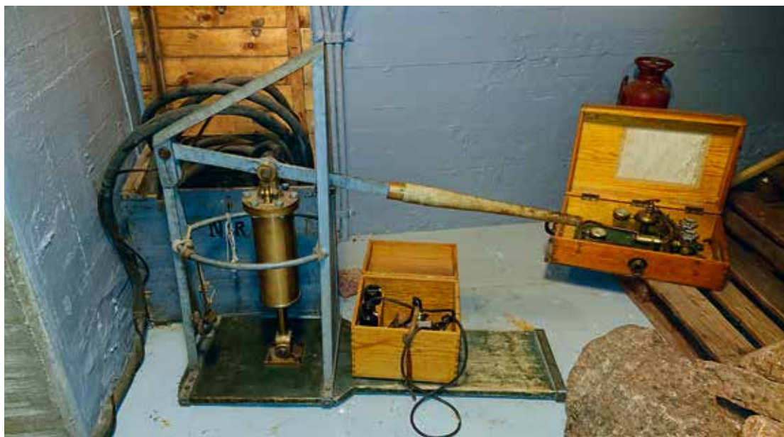
Med denna encylindriga luftpump från Emil Carlsson kan besökarna pumpa luft till dykarhjälm. Bredvid pumpen syns slanglåda, dyktelefon och slangdykarmanifold.
