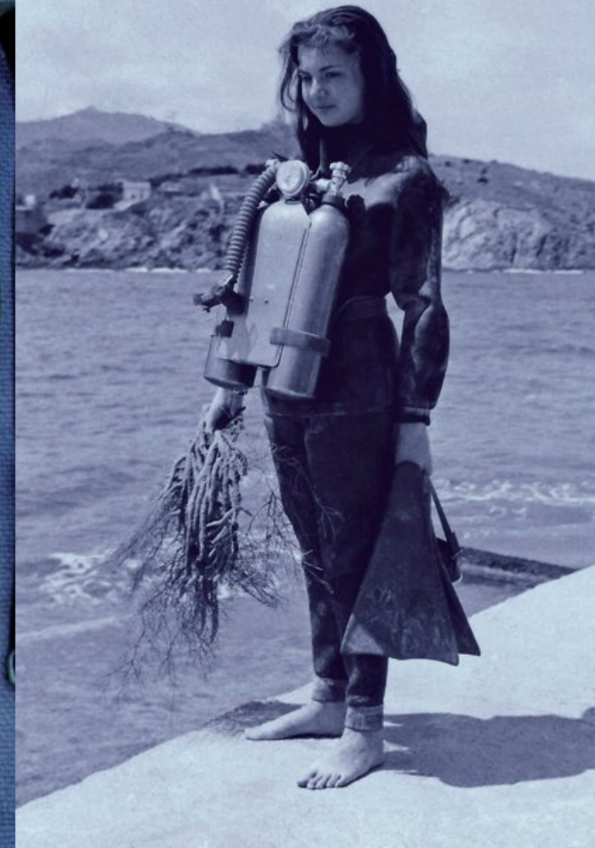
POUMONDEAU Ventral. Le tuyau annelé en caoutchouc bleu n'a pas résisté à l'épreuve du temps (photo Ph. ROUSSEAU)
