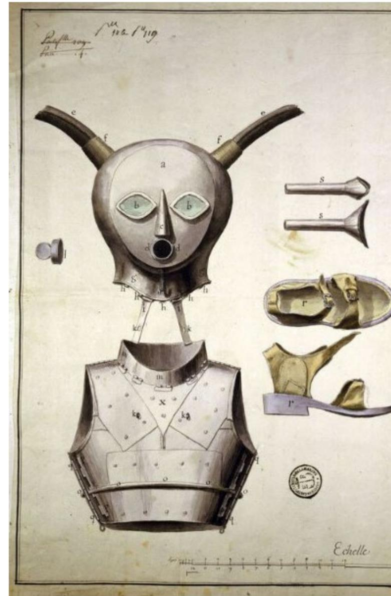
Le deuxième tuyau remonte du casque vers la surface. Il permet la ventilation du casque en assurant la création d'une circulation d'air. Cette circulation d'air permet deux choses : éviter le gonflement du vêtement sous l'action d'un afflux trop important d'air en provenance du soufflet et assurer la circulation de l'air « vicié » par la respiration depuis le casque vers la surface.
