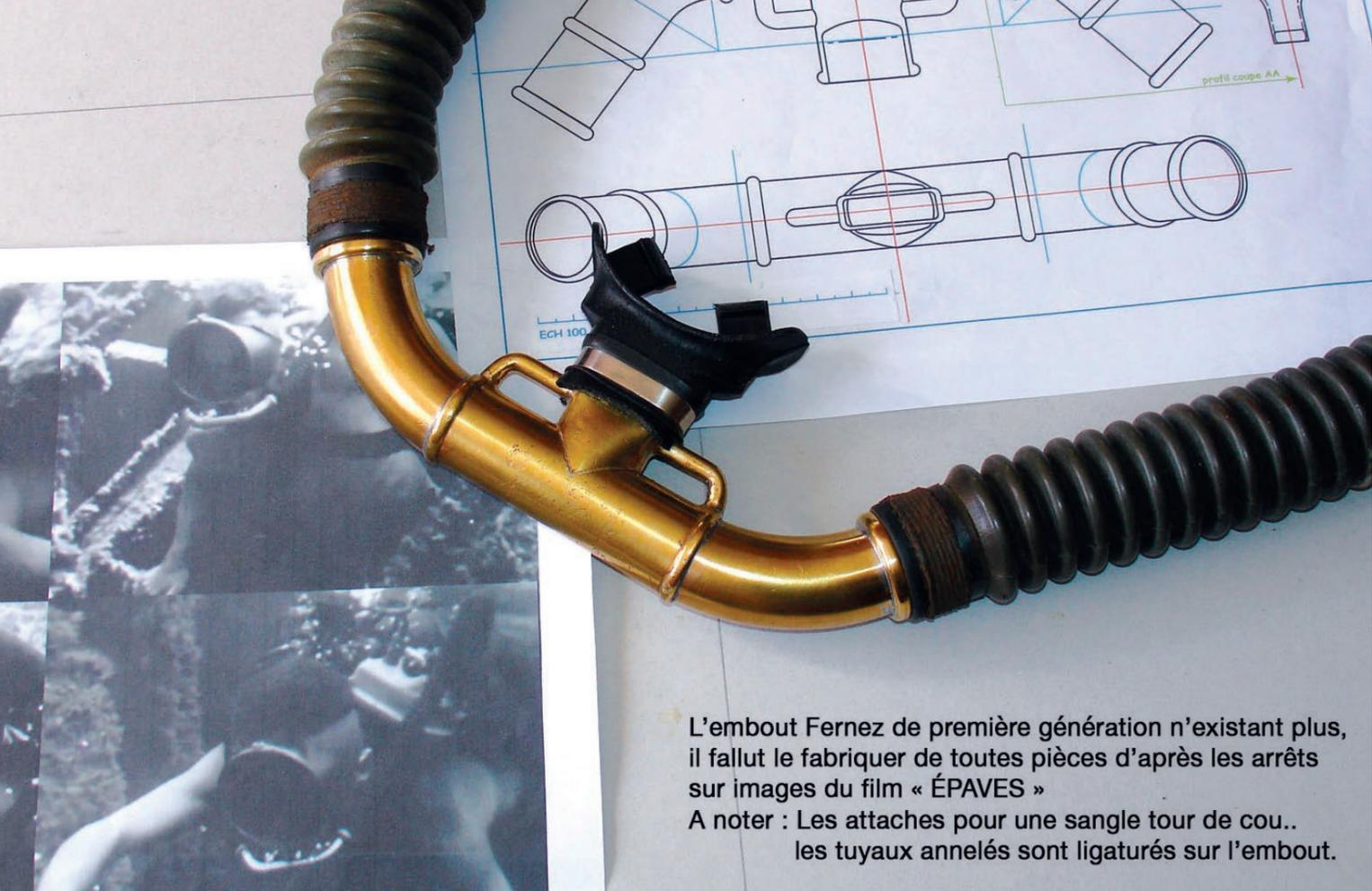
L'embout Fernex de première génération n'existant plus, il fallut le fabriquer de toutes pièces d'après les arrêts sur images du film « ÉPAVES »
